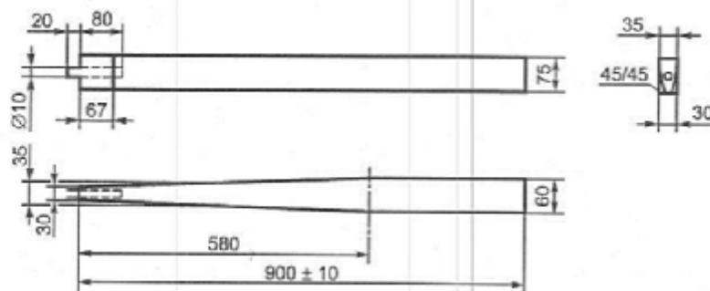
Рисунок Б.3 — Размеры рукоятки топора (молотка)
