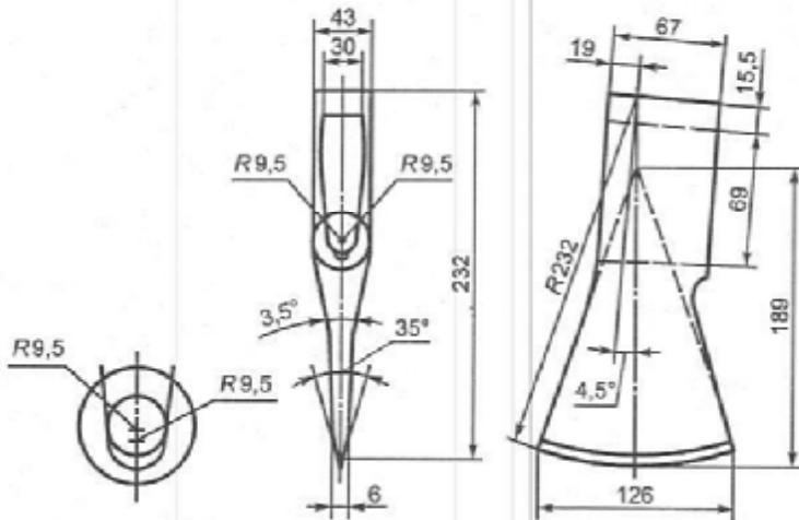
Рисунок Б.2 — Форма и размеры головки топора
