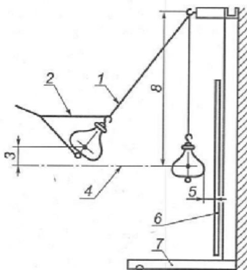
1 — трос; 2 — узелка для подъема мешка; 3 — высота падения мешка; 4 — центр образца; 5 — расстояние между образцом и мешком, висящим в свободном состоянии; 6 — испытываемый образец, закрепленный в раме; 7 — спора; 8 — высота подвеса
