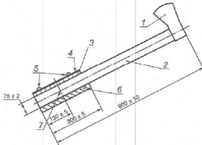
1 — головка топора; 2 — рукоятка; 3 — стальная пластина; 4 — зажимное приспособление, 5 — винты; 6 — резиновая полоса;
