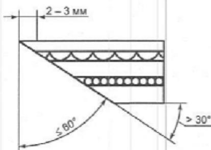
Рисунок А.7 — Обработанный фацетированный край
