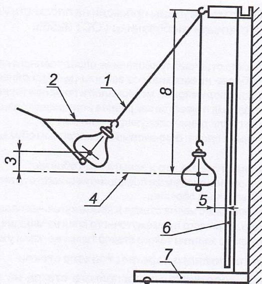
1 — трос; 2 — узелка для подъема мешка; 3 — высота падения мешка; 4 — центр образца; 5 — расстояние между образцом и мешком, висящим в свободном состоянии; 6 — испытуемый образец, закрепленный в раме; 7 — опора; 8 — высота подвеса
