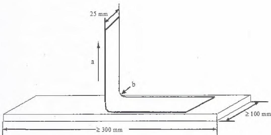
а – направление усилия отрыва, б – угол отрыва
