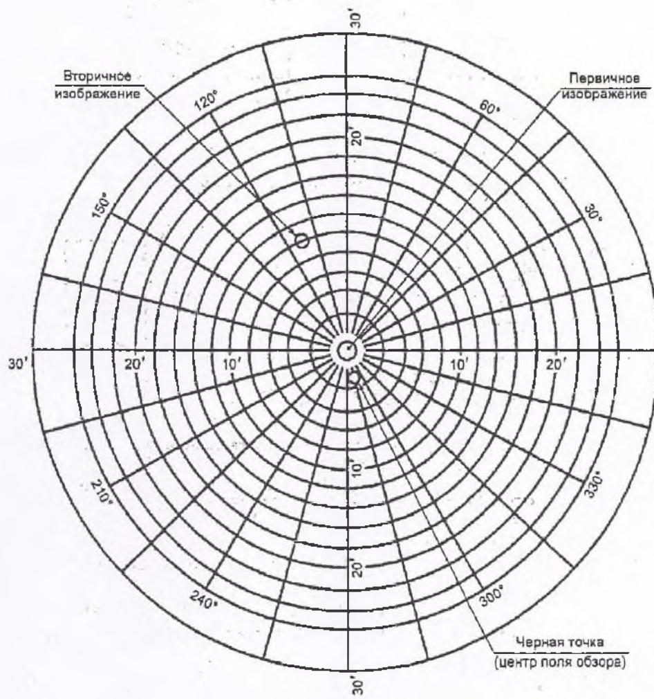
Рисунок 7.9 – Пример наблюдения по методу испытания с коллиматором
