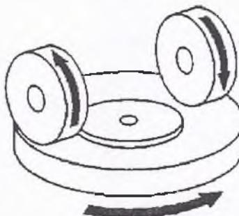
Рисунок 7.15 — Схема приспособления для проведения испытания на абразивную стойкость
