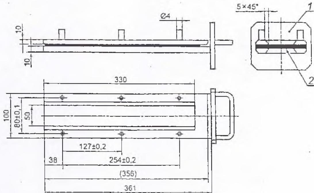
1 — крышка; 2 — испытуемый образец
