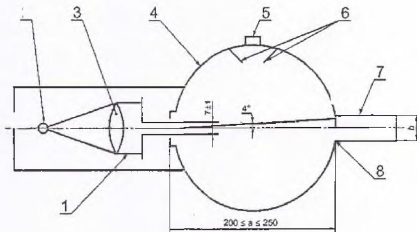
1 – параллельный световой пучок; 2 – источник света; 3 – линза; 4 – интегрирующая сфера; 5 – фотоэлемент; 6 – отражатели; 7 – световая ловушка; 8 – относительное отверстие световой ловушки;  $a$  – диаметр сферы;  $b$  – диаметр выходного отверстия
