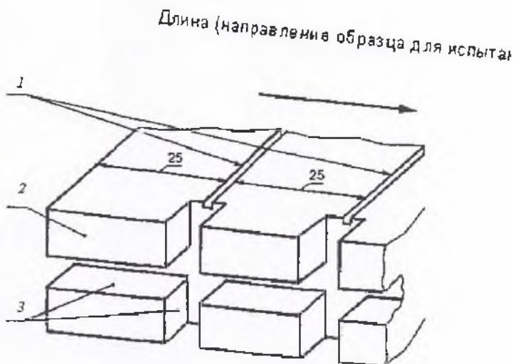
1 — щели размерами  $0,5 \times 0,5$  мм; 2 — внешний край рамы; 3 — вырезы размерами  $2 \times 2$  мм
