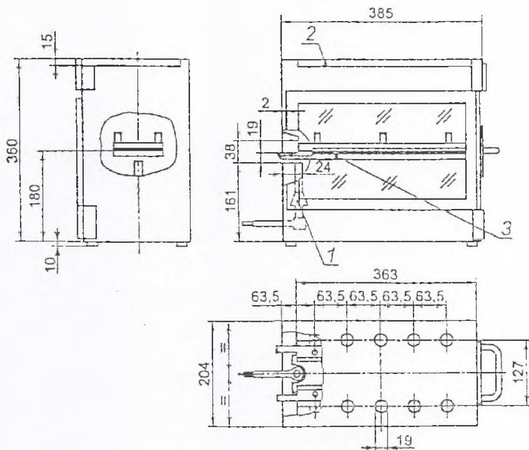
1 — газовая горелка; 2 — вентиляционная щель; 3 — испытуемый образец
