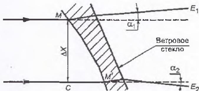
$\Delta\alpha = \alpha_1 - \alpha_2$  – оптическое искажение в направлении  $MM'$ ;  $\alpha_1$  – оптическое отклонение в точке  $M$ ;
